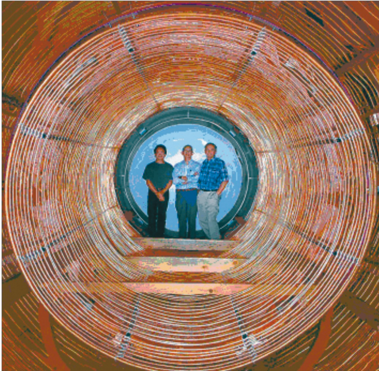
Рис. 22. Фотография первичной обмотки ускорительной трубки
