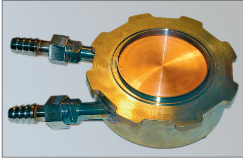
Рис 71. Фотография мишенного узла с приемником пучка
