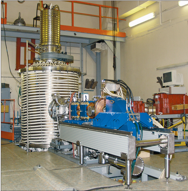
Рис. 55. Фотография ускорителя-тандема с вакуумной изоляцией
